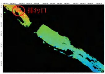
无人机光谱成像指数分析仪监测河流工厂排污口
